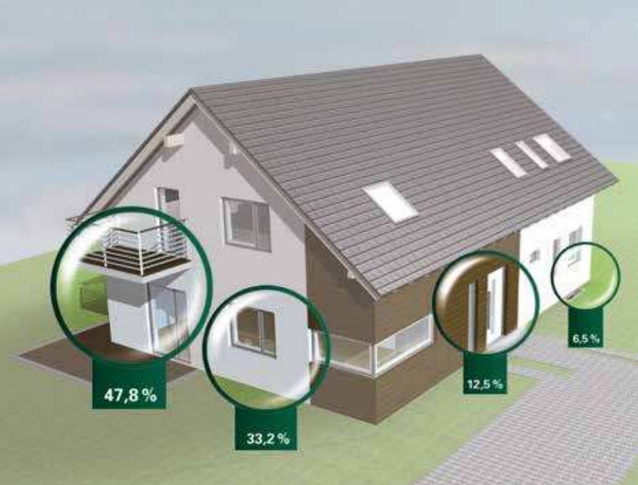
einbruchgefährdete Bereiche am Einfamilienhaus
